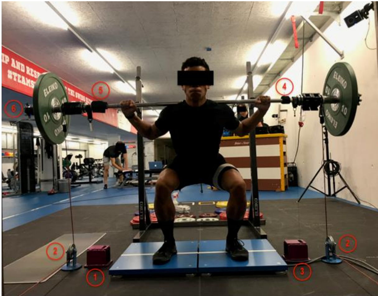
Abbildung 1. Geschwindigkeitsbasierte Messsysteme. 1 = Gymaware, 2 = Quantum, 3 = Speed4lifts, 4 = Vmaxpro, 5 = Push, 6 = Flex.
